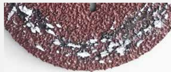
Mit Aluminiumspänen zugesezte Fiberscheibe
