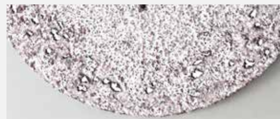
VSM STEARAT Plus: Es haften sichtbar deutlich weniger Späne an.
